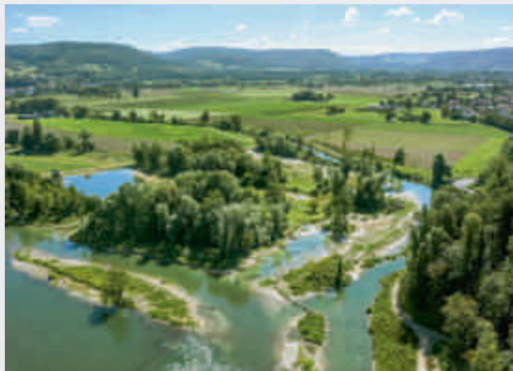
Fig. 1 Bei der ökologischen Aufwertung des Chly Rhy bei Koblenz (AG) wurde unter anderem ein zugeschütteter 1,5 Kilometer langer Seitenarm des Rheins wieder freigelegt, der nun bei Hochwasser über die Ufer tritt. So ist eine dynamische Uferlandschaft entstanden.
